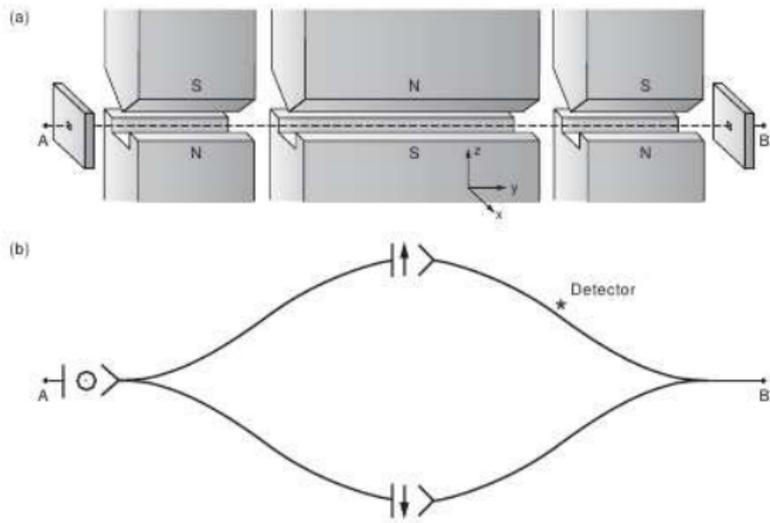
Figure : Stern-Gerlach apparatus
